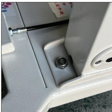
1. Verschrauben Sie den Stand (B) mit dem Sockel (C) mit Schrauben (G), Beilagscheiben (E) und Federschrauben (F)
