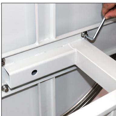
4. Arbeitsplatte (A) mit Stand (B) mit Schrauben (G), Scheiben (E) und Federschrauben (F) befestigen.
