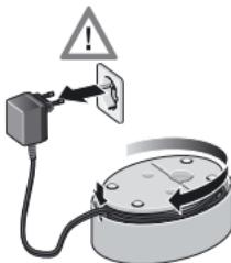
Si no necesita toda la longitud del cable, se puede guardar una parte del cable de conexión en el depósito de cable **9**.
