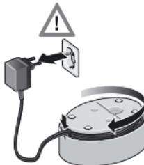
Если нет необходимости использовать провод на всю длину, можно разместить часть соединительного провода в месте для хранения кабеля 9.
