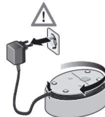
Wenn Sie nicht die volle Länge der Leitung benötigen, kann ein Teil der Anschlussleitung im Kabeldepot **9** verstaut werden.
