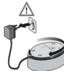
Se non utilizzate la lunghezza totale del cavo, una parte del cavo di collegamento può essere alloggiata in un vano portacavi 9.
